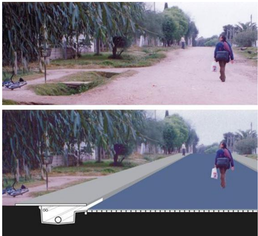
Figura 9: Fotomontagem representando a implantação do sistema “Calçadas Drenantes” de drenagem superficial em áreas de assentamento precário.
