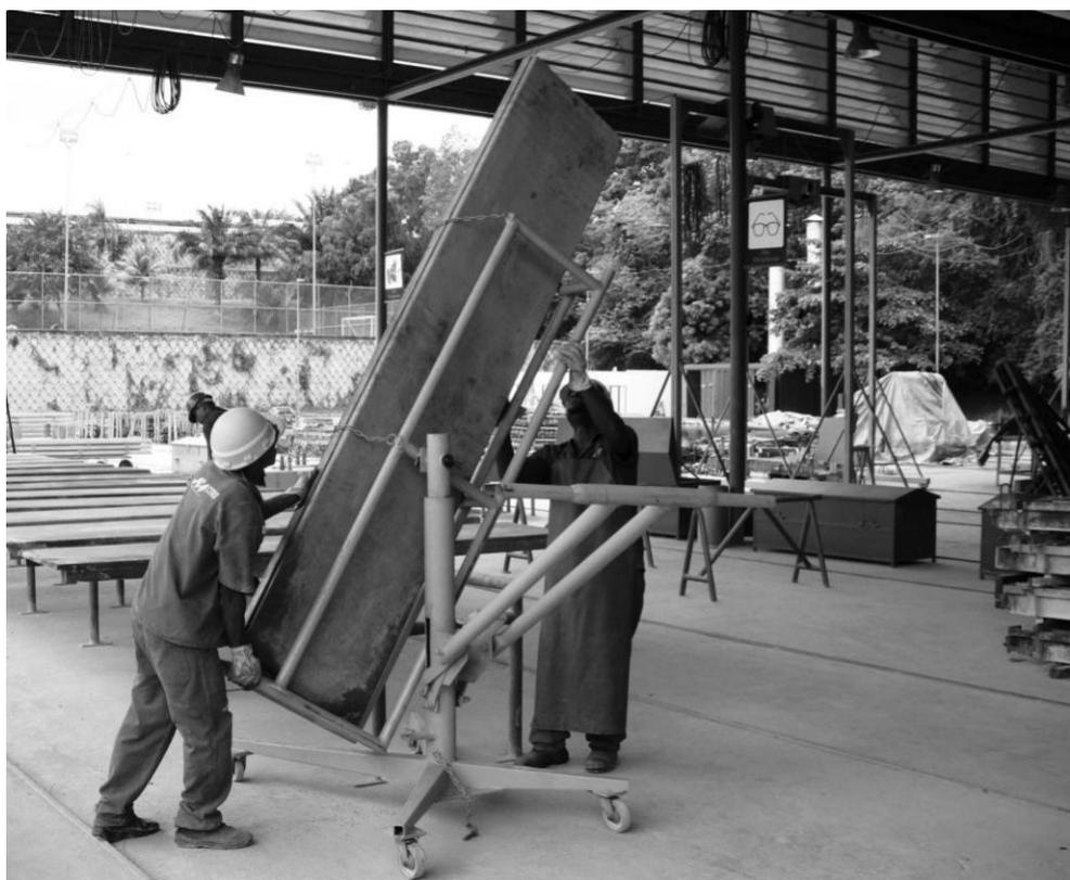
**Fig. 4** – Produção de pré-fabricados de microconcreto no CTRS (Salvador, 2008)
