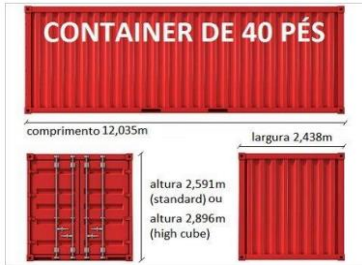
Figura 10 Medidas do contêiner utilizado
