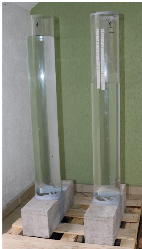
FIGURA 20 — TUBOS ACRÍLICOS FIXADOS NOS CORPOS DE PROVA
