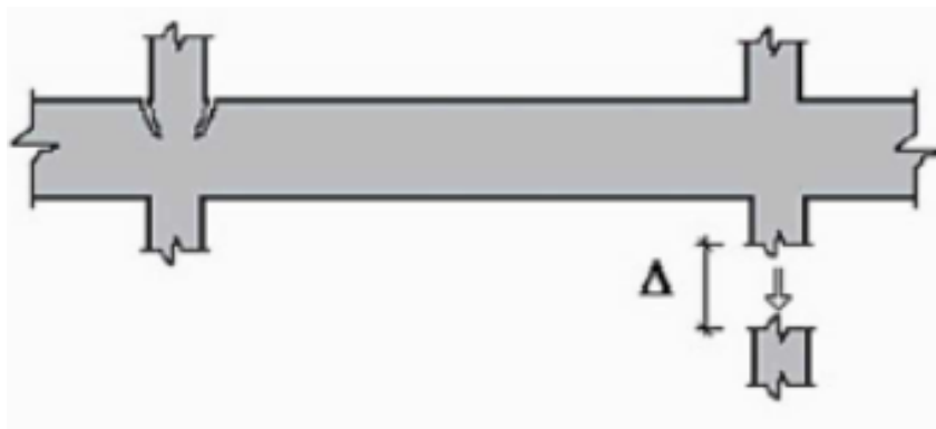
FIGURA 9 — RECALQUE DIFERENCIAL DOS APOIOS GERA FISSURAÇÃO
