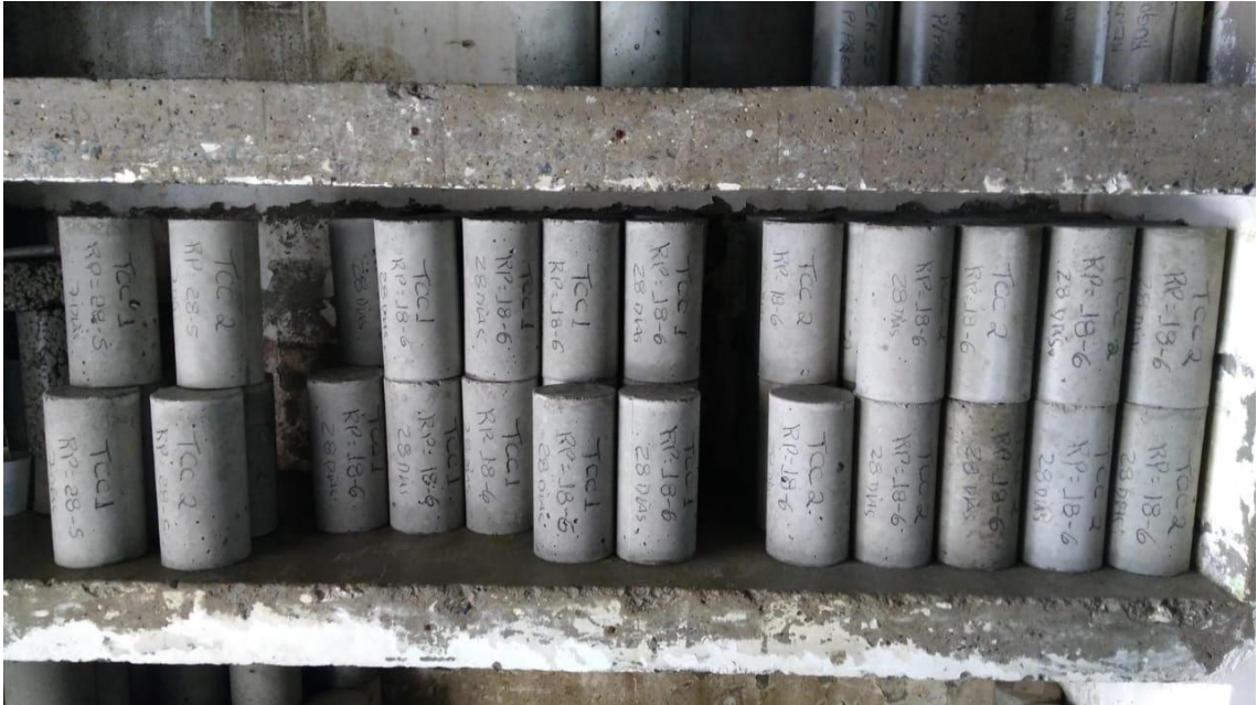
FIGURA 16— CORPOS DE PROVA CILÍNDRICOS APÓS DESFORMA
