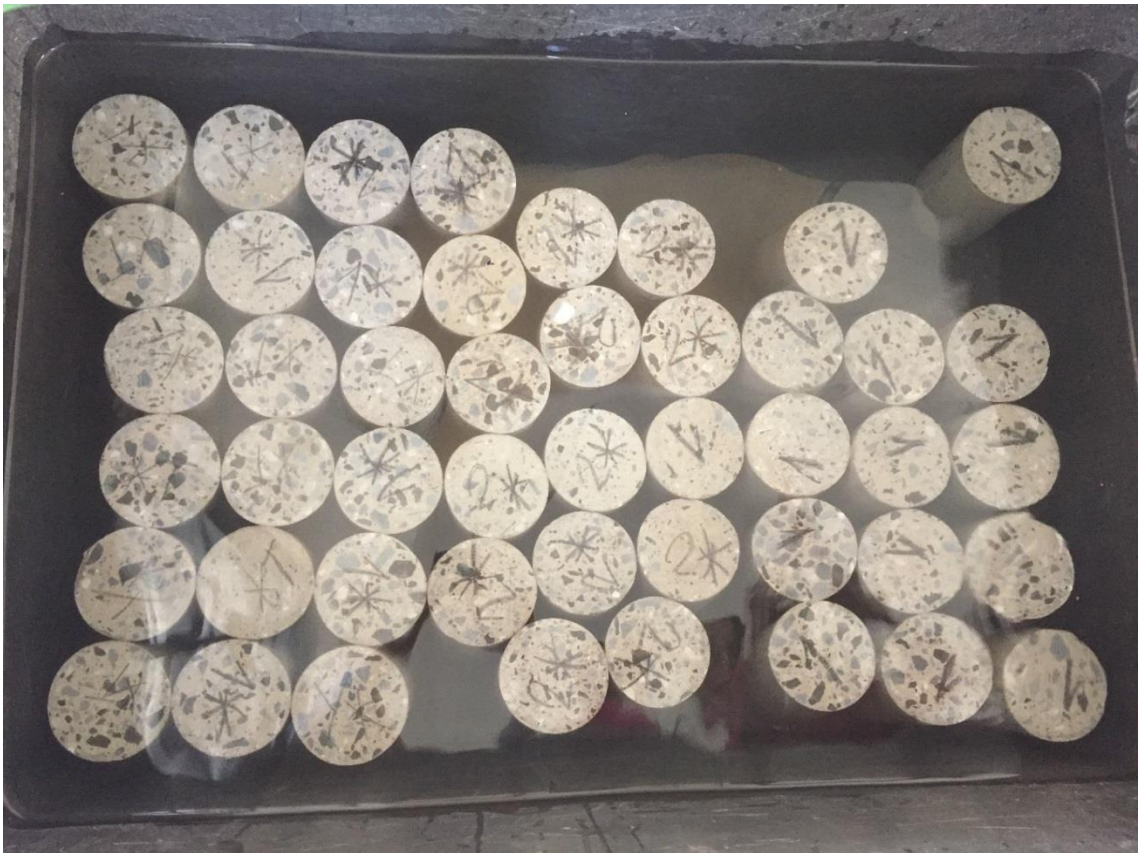
FIGURA 17 — CORPOS DE PROVA IMERSOS EM ÁGUA
