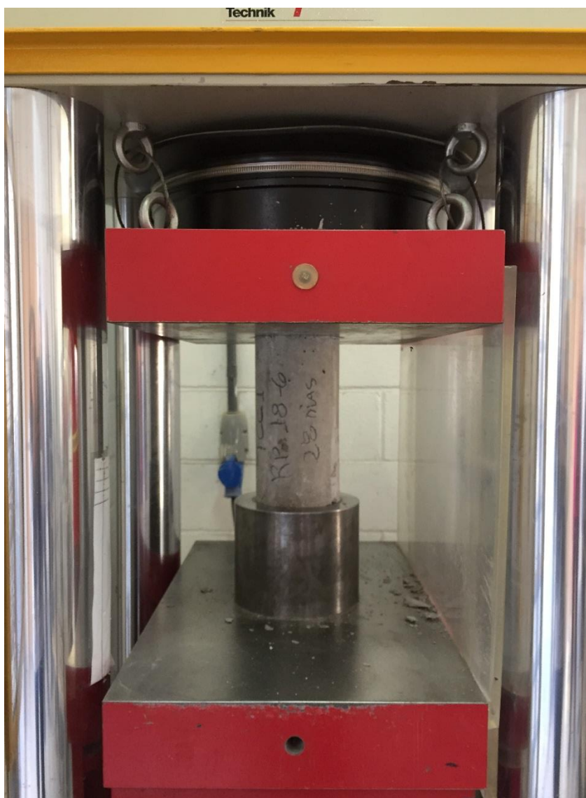
FIGURA 18 — ROMPIMENTO DOS CORPOS DE PROVA À COMPRESSÃO
