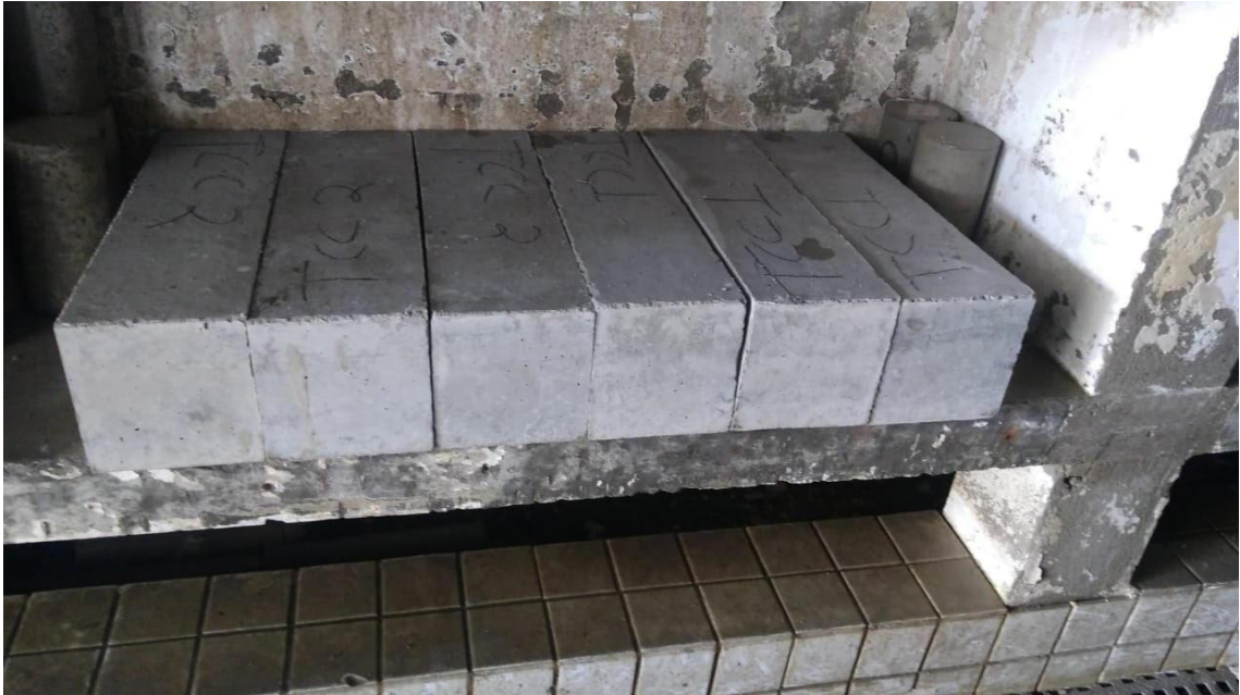
FIGURA 19— CORPOS DE PROVA PRISMÁTICOS APÓS DESFORMA
