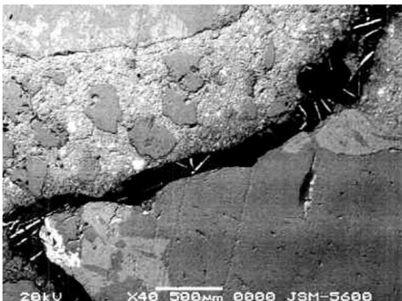
FIGURA 12—CRISTAIS AO LONGO DA FISSURA
