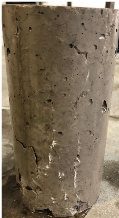
FIGURA 24 — EVIDÊNCIA DE CRISTALIZAÇÃO EM CORPO DE PROVA CILÍNDRICO
