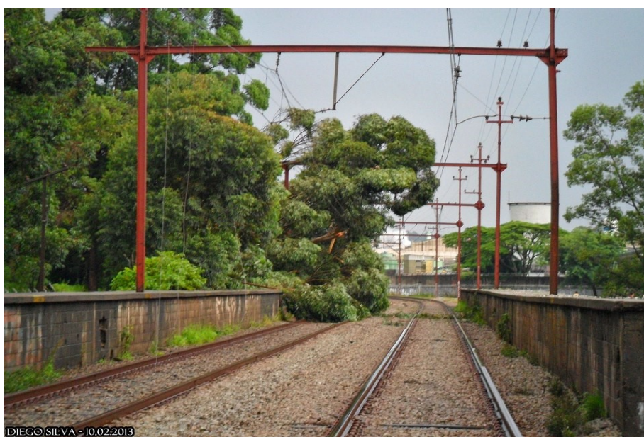
Figura 8. Foto de árvore caída sobre Rede Aérea. Fonte: Silva, 2013.
