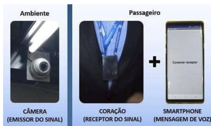
Figura 1 - Componentes do sistema SigaFácil: câmeras, coração e smartphone
