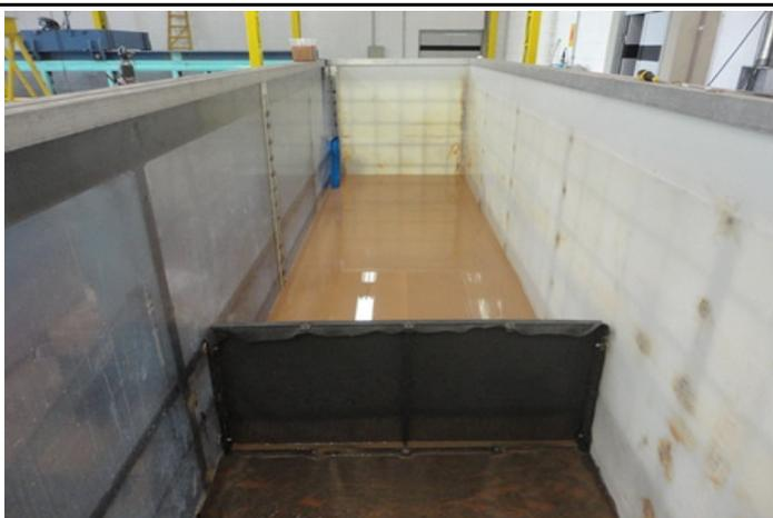
Foto B70: Efluente que ultrapassa a cerca filtrante apresenta grande turbidez.
