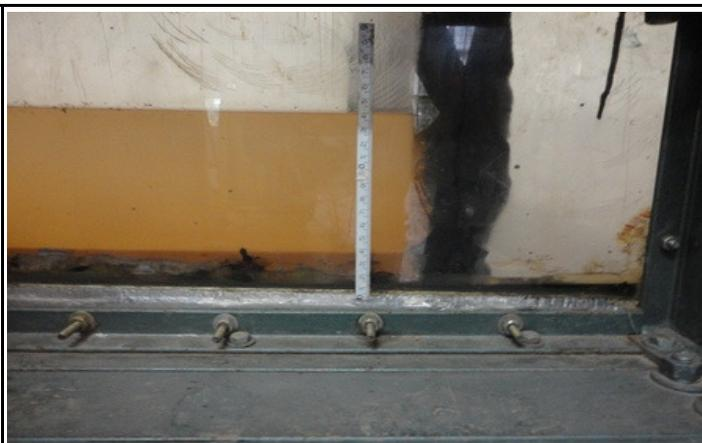
Foto B60: Após 15 minutos da imagem ao lado, ainda há retido 13,6 cm de efluente junto a cerca filtrante (0,1cm corresponde a 3,8 litros).
