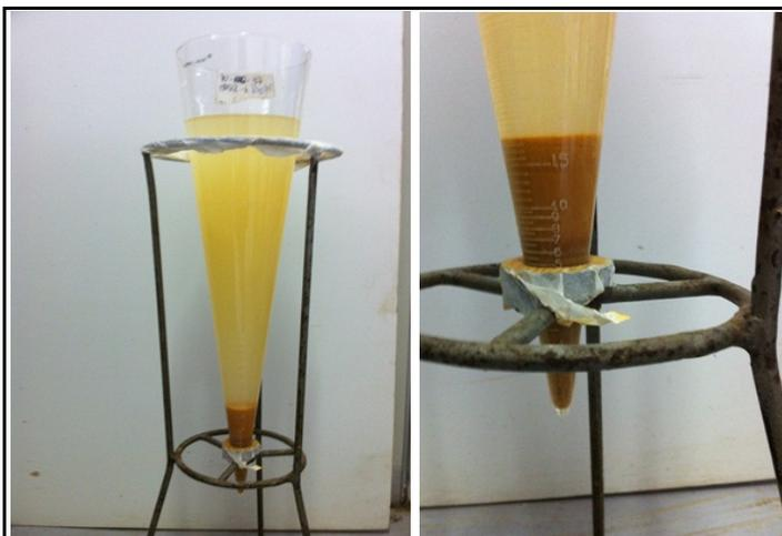
Foto B49: Amostra 70 em ensaio de 1 hora em cone de Imhoff.
