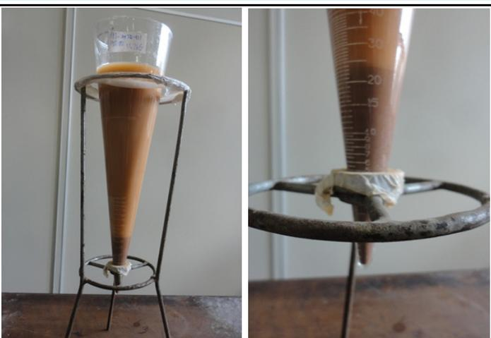
Foto B74: Amostra 111 em ensaio de 1 hora em cone de Imhoff.
