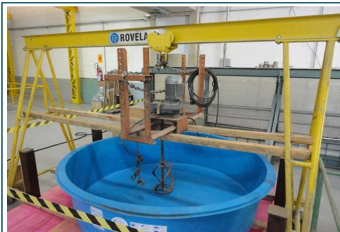
Foto B5: Caixa d'água 1, cavalete metálico e misturador.
