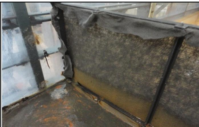
Foto B26: Membrana geotêxtil praticamente colmatada após 10 minutos de ensaio.
