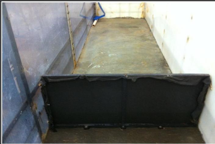
Foto B64: Tanque limpo e cerca filtrante fixa, prontos para início do ensaio.
