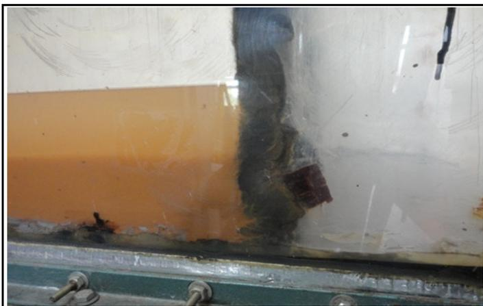
Foto B25: Efluente retido na cerca (aproximadamente 10 minutos de ensaio). Observa-se rápida decantação dos sedimentos.
