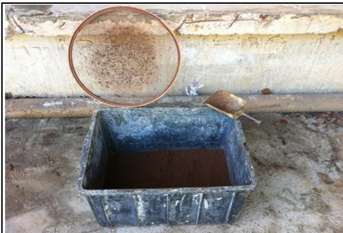
Fotos B65 e B66: Peneiramento do solo argiloso e lançamento na caixa 1 para preparação do efluente.
