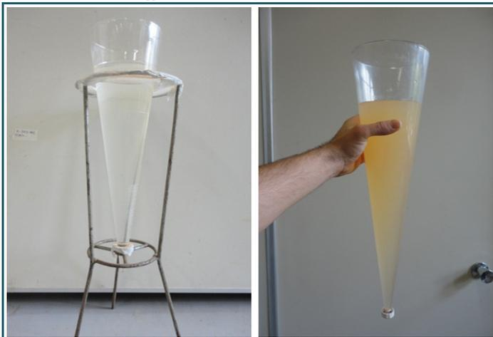
**Foto B11: Cone de Imhoff de vidro e acrílico**
