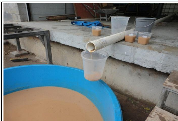
Foto B73: Efluente sendo coletado na entrada da caixa 2.
