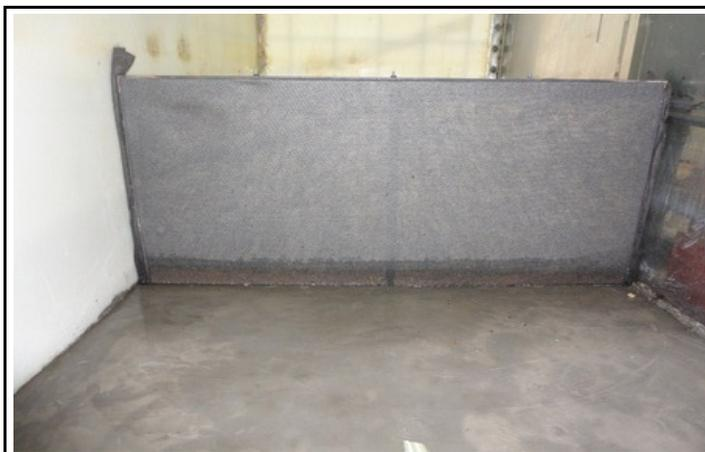
Fotos B17 e B18: Cerca filtrante após o ensaio apresenta coloração marrom na faixa onde a água atravessou.
