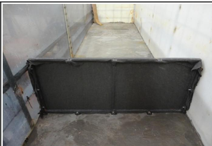
Foto B48: Cerca filtrante fixada no tanque, com laterais e base vedadas
