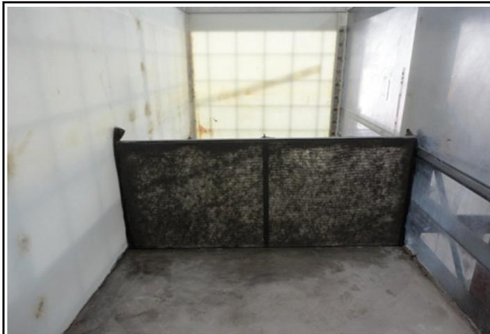
Foto B15: Cerca filtrante fixa no tanque para o ensaio.
