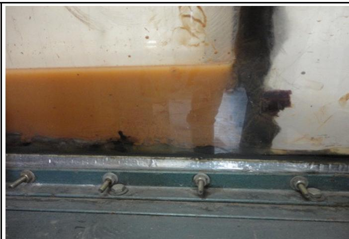
Fotos B29 e B30: Tanque após o ensaio com efluente retido antes da cerca filtrante.
