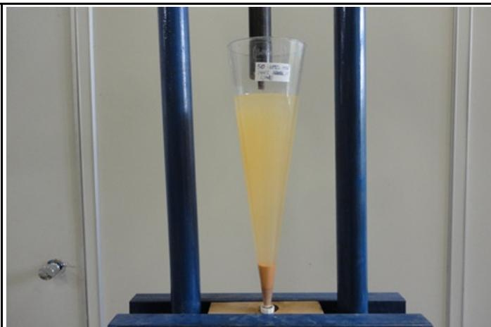
Foto B44: Amostra 50 em ensaio de 1 hora no cone de Imhoff.
