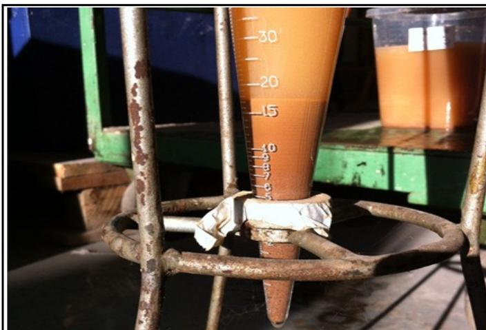
Foto B67: Amostra 100 em ensaio de 1 hora em cone de Imhoff.
