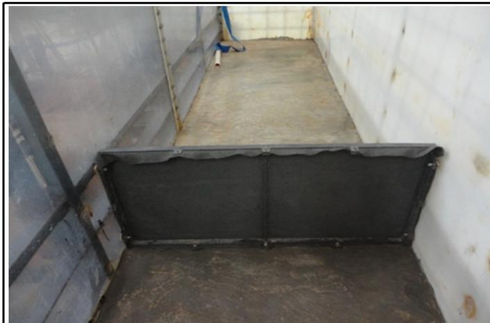
Foto B69: Tanque e cerca filtrante preparados para início do ensaio.
