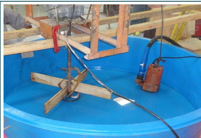
Foto B8: Detalhe aleta de madeira e bomba
