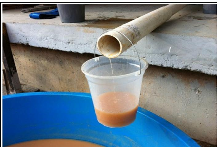
Foto B68: Após 1h de ensaio o efluente ainda apresenta grande turbidez.
