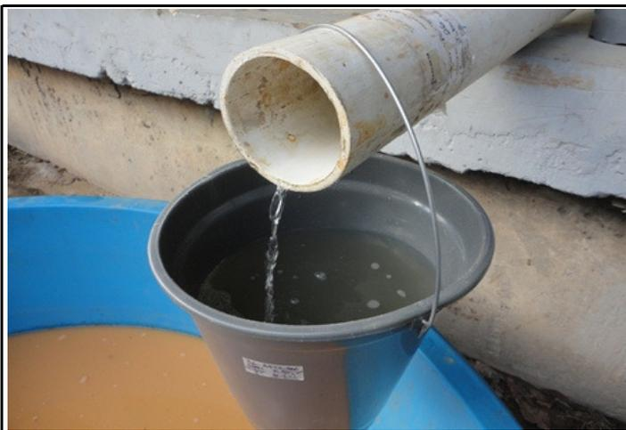
Foto B61: Efluente isento de sólidos sedimentáveis na entrada da caixa 2 após 15 minutos de ensaio
