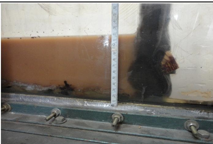
Fotos B71 e B72: Ensaio em andamento, cerca filtrante funciona como barreira, reduzindo muito a vazão.
