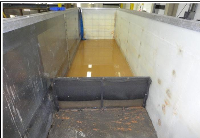
Foto B62: Após 25 minutos de ensaio o cerca atua com barreira do efluente.
