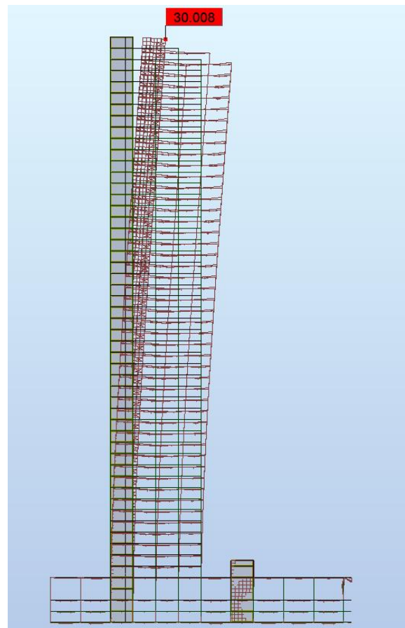
Figura 107 – Configuração final da deformada da estrutura no caso ELS
