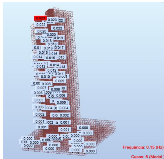
Figura 78 – Deslocamentos obtidos no 1º modo da análise modal
