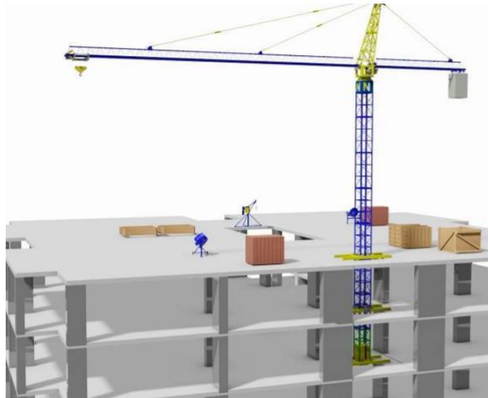
Figura 121 – Esquema ilustrativo de grua ascensional
